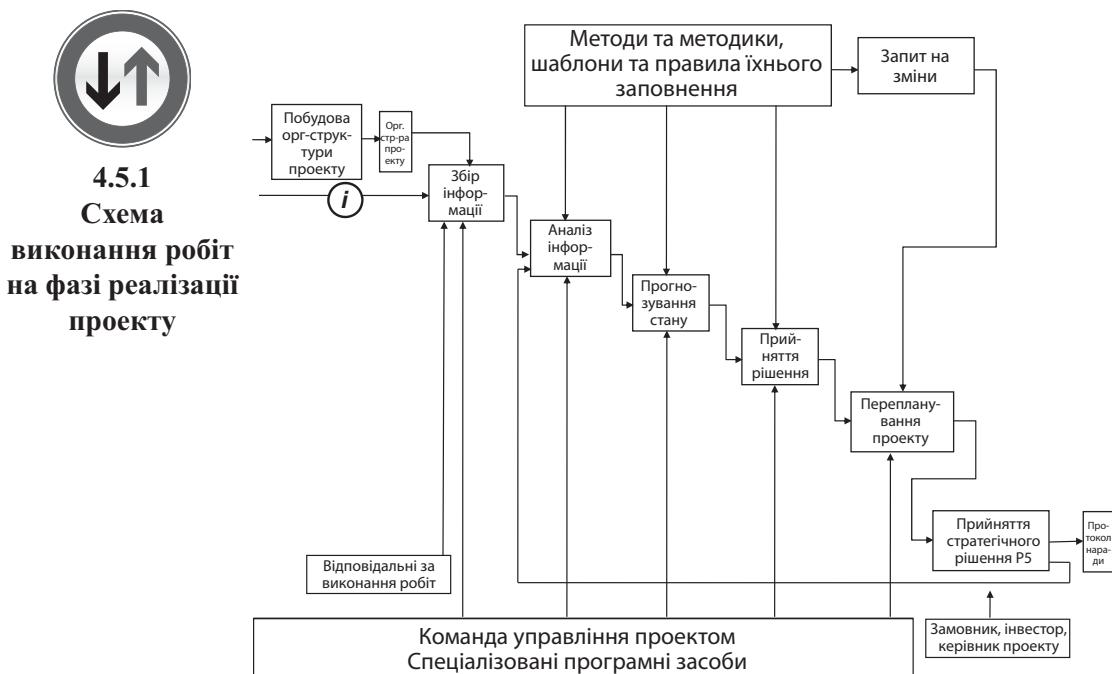
**Рис. 4.15. Схема виконання робіт на фазі реалізації проекту**
